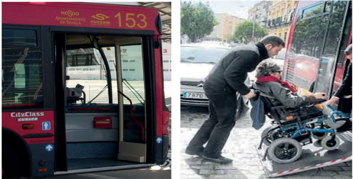
Figura 2: Las instalaciones de autobuses de Sevilla permiten subir y bajar a las personas con problemas de movilidad.
